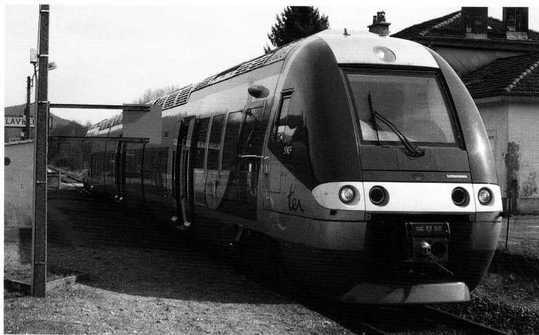
L'AGC, sorti au début des années 2000, a fait un premier pas vers une traction plus écologique, dans sa version bimode, électrique et diesel, pour les lignes non-électrifiées, ce qui était alors une première mondiale.
