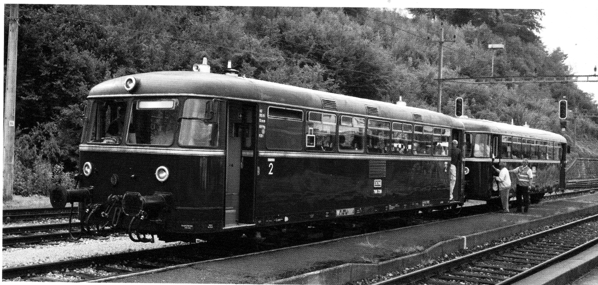
Apparu au tout début des années 50, et utilisé commercialement par les Chemins de fer allemands jusqu'en 2000, le célèbre « Schienenbus » (autobus sur rail) fut l'un des très rares autorails légers à deux essieux à avoir connu un retentissant succès, avec plus de 3 000 caisses construites. Ici, deux d'entre elles parfaitement préservées, à Coblenze, le 22 août 2009.
