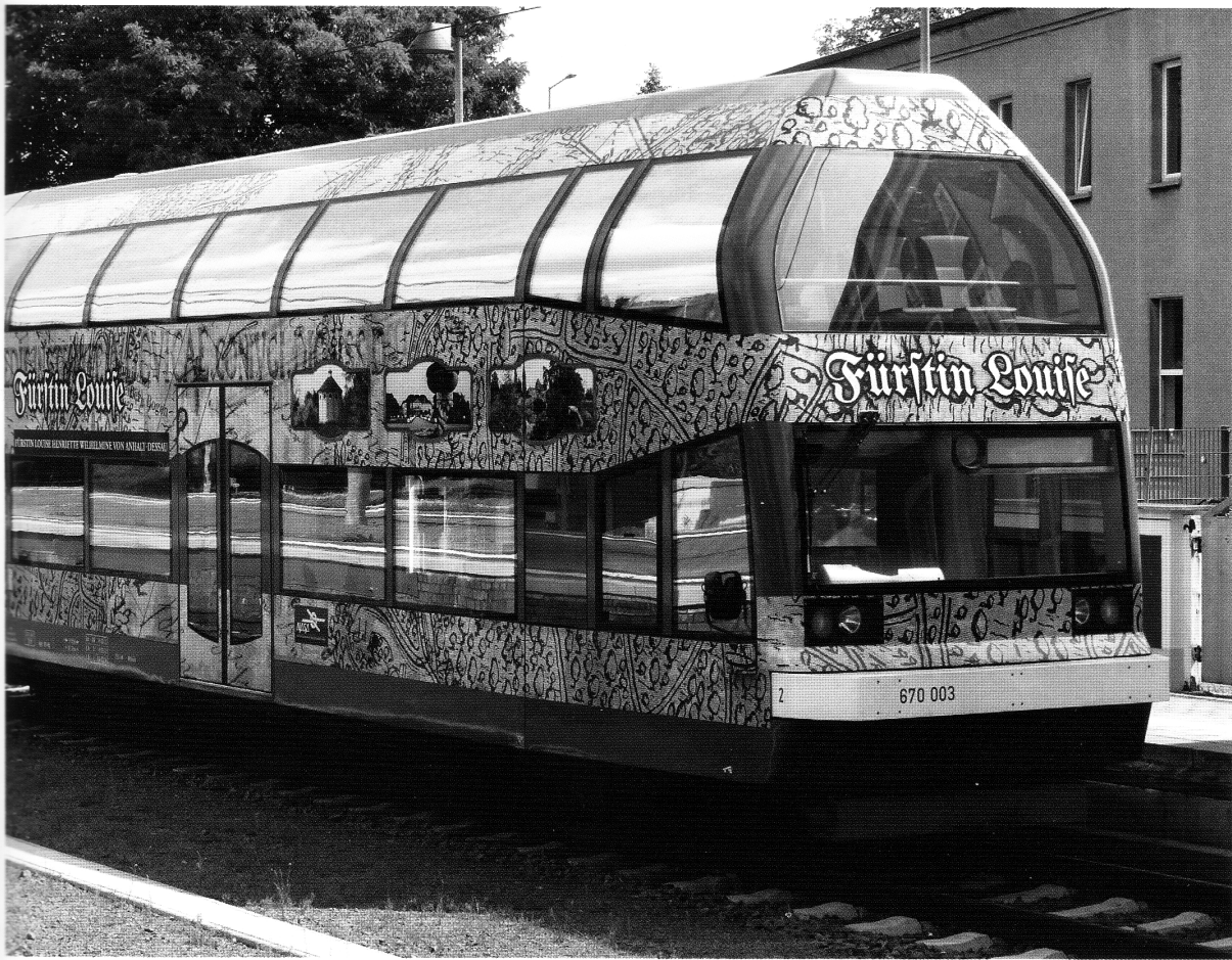
En gare centrale de Dessau (Allemagne), le VT 670-003 « Princesse Louise » est l'un des deux autorails à deux niveaux et deux essieux à avoir originellement repris du service sur la ligne Dessau - Wörlitz, chez l'opérateur privé DVE (Dessauer Verkehrs und Eisenbahn Gesellschaft, société des transports et du chemin de fer de Dessau). À la Deutsche Bahn, cet autorail portait, en réalité, le numéro 006 (1 er juin 2018)
